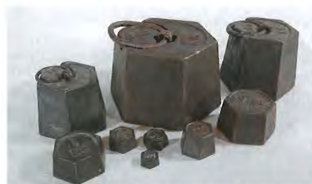
Zu jeder Dezimalwaage gehören Gewichtssteine, in der Regel zwischen 50 g und 20 Kilogramm.
